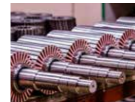
Aufkleben von Blechpaketen, Kommutatoren und Lagern
