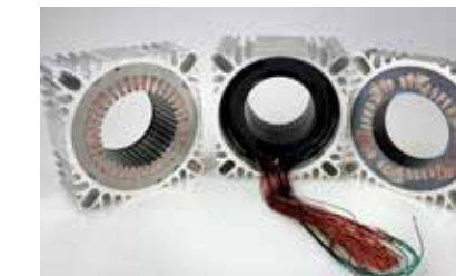
Projekt: Verguss Stator (Industriemotor)
