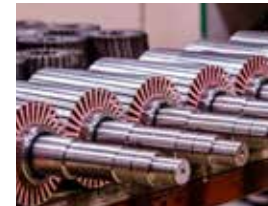
Aufkleben von Blechpaketen, Kommutatoren und Lagern
