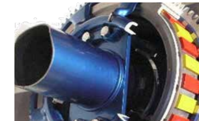
Projekt: Magnetverklebung Retarder
