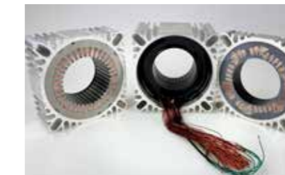
Projekt: Verguss Stator (Industrie- motor)
