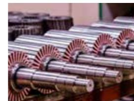
Aufkleben von Blechpaketen, Kommutatoren und Lagern
