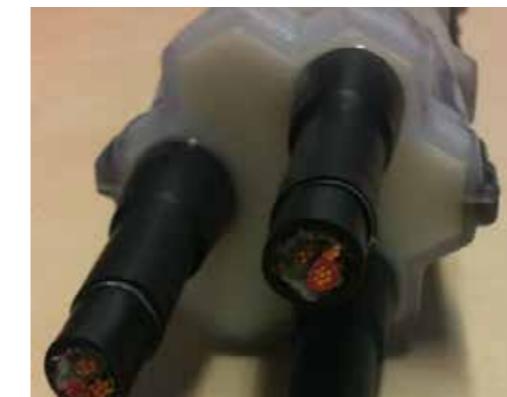
Vergießen und Dichten von Kabeldurchführungen und Gehäusen
