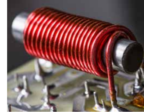
Fixieren und Sichern von Ferriten in Luftpulen
