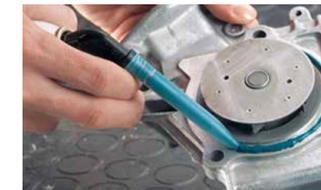
**Projekt:** Abdichten eines Pumpengehäuses mit Silikon
