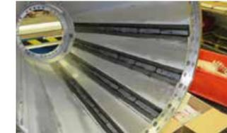
**Projekt:** Einkleben von Metallschienen in Separatortrommel
