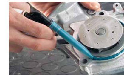
Projekt: Abdichten eines Pumpengehäuses mit Silikon
