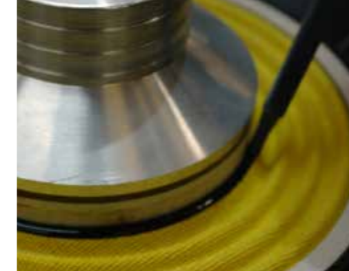
Verkleben der Dämpfung mit der Schwingspule
