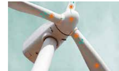
Projekt: Sensor einkleben in Windblatt
