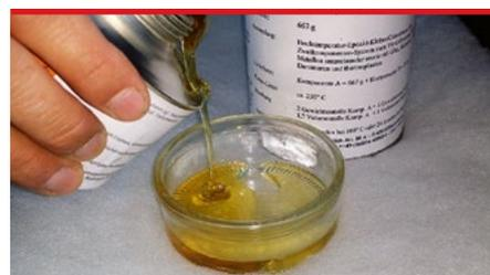
**Der 2K-Reaktionsklebstoff Epoxy 4439 ist temperaturbeständig von -40 °C bis +250 °C und deckt ein großes Anwendungsgebiet ab**
